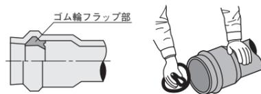
**3** そのまま受口のゴム輪溝の位置に入れ、ゆっくりと手をゆるめてゴム輪を装着します。ゴム輪が正しく装着されたかどうかを必ず確認し、ねじれやずれがあれば修正してください。
